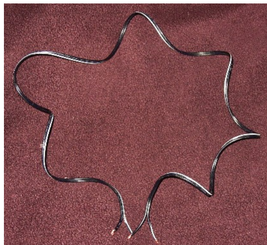
Piros görbe az alábbi grafikonon – kéteres hangszóróvezetékéből készült Ruthroff transzformátor.
