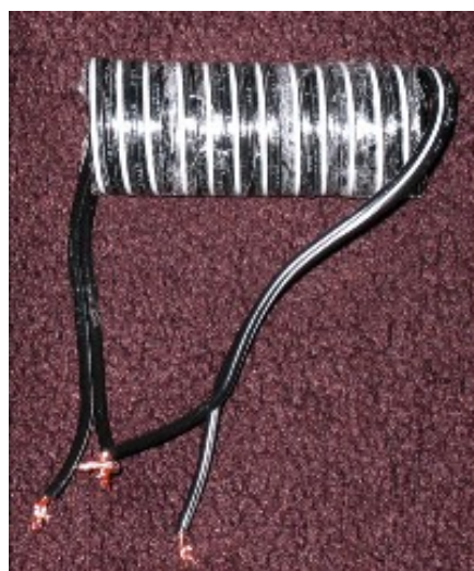
Zöld görbe az alábbi grafikonon – kéteres hangszóróvezetékéből készült, 4:1-es Ruthroff, légmagos transzformátor.
